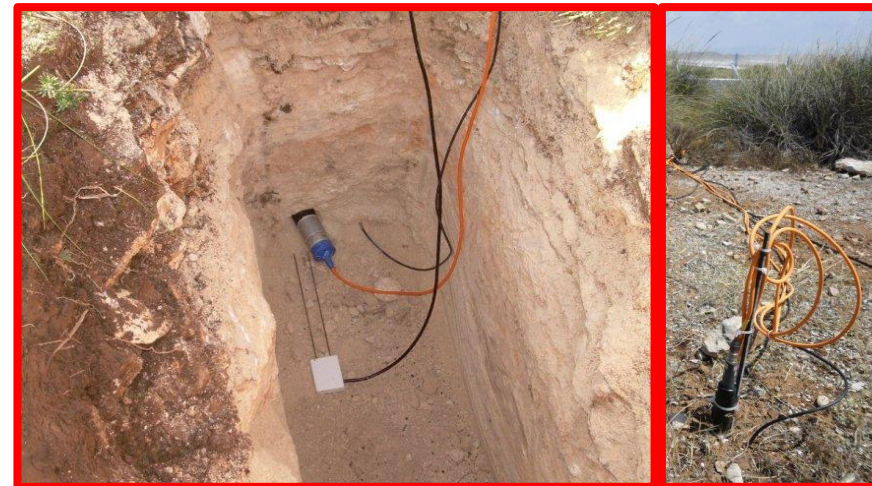
Gradient method ( \text{CO}_2 , \text{H}_2\text{O} – R_{\text{soil}} & E, soil efflux)
